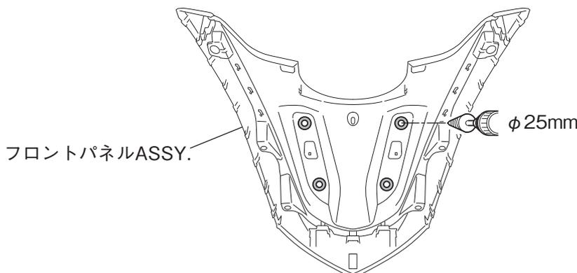
3. スタンダード車のウェルナットを取り外し、ナット⑧を車両に取り付けます。
