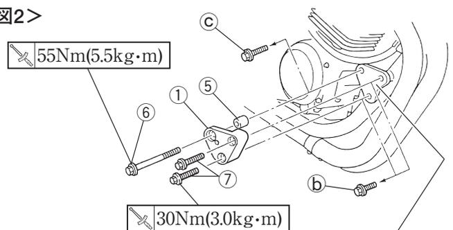
2. &lt;図3&gt;のようにレーシングプロテクターを組み付けます。
