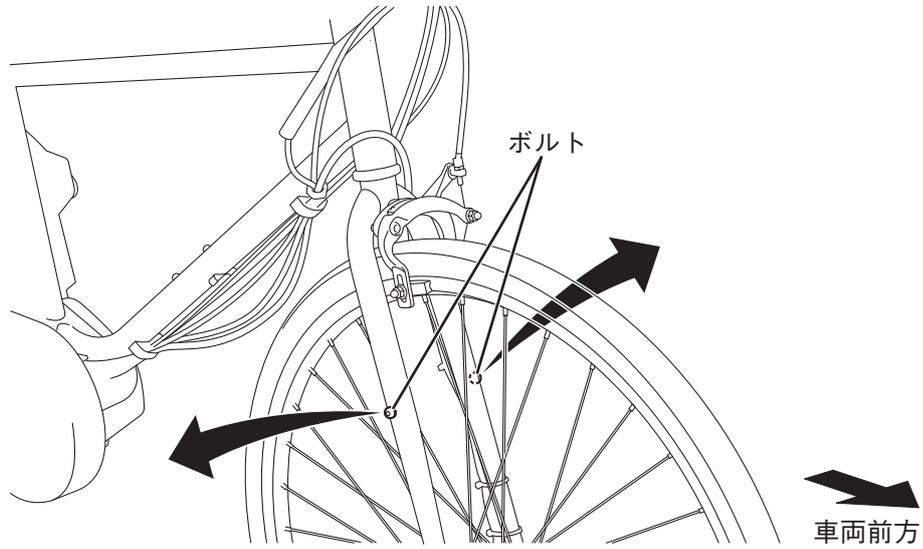
2. 車両のフロントキャリパーブレーキを取り外します。
