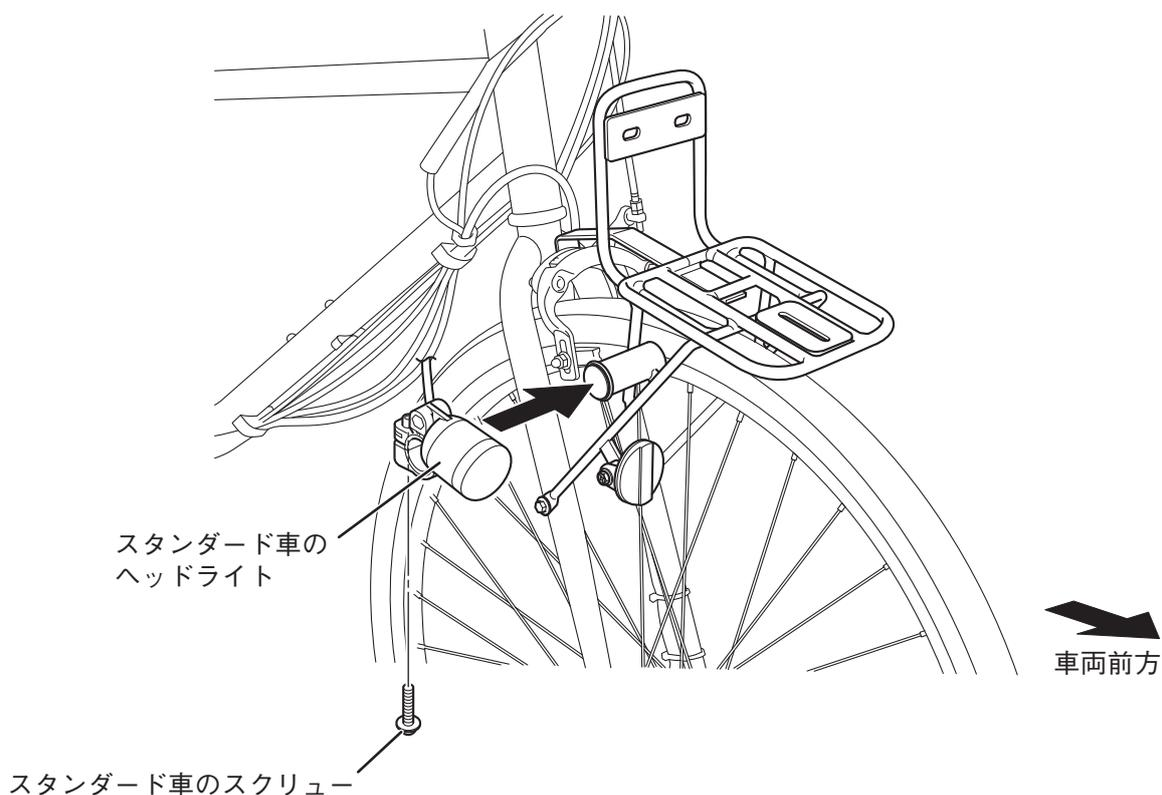
7.下図を参考に、ヘッドライトのハーネスをクランプ⑧で仮止めします。ハンドルを左右に切って、ハーネスが突っ張らないことを確認してからクランプ⑧を締め、余り部分を切り取ります。
