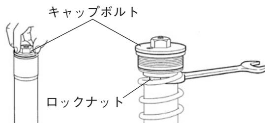
4. スタンダード車のフォークスプリングとOリングを、キットのフロントフォークスプリング①とOリング②に交換します。☞
