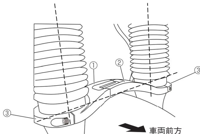
1. 車両左側から作業をします。スタンダード車のフォークプロテクターの下にフォークブレースL②とクランプ③をソケットヘッドボルト④で仮組みします。
