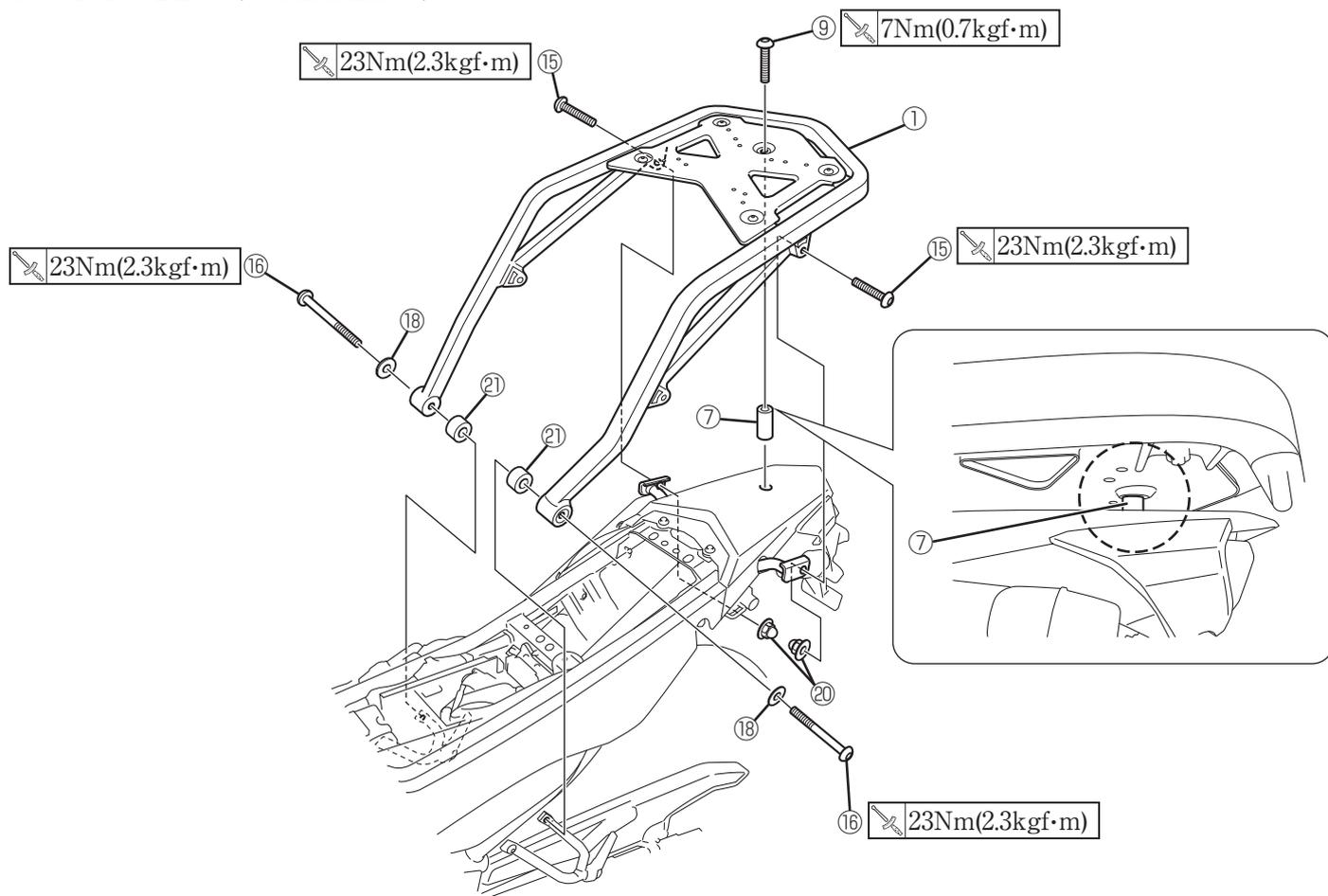
15.同時に仮止めしていたスタンダード車のボルトを規定のトルク値で締め付けます。
