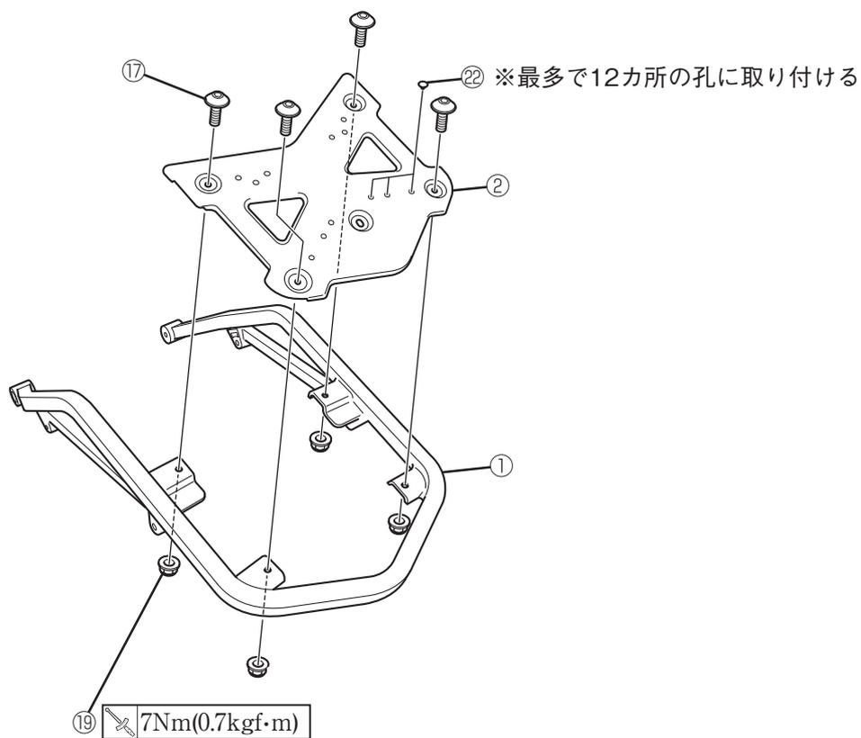
14.プレートキャリア②の下にボス⑦を置き、キャリアASSY.①を下図を参考に取り付けます。車両前側はカラー②とワッシャ⑱をはさみます。この時、プレートキャリア②下面とボス⑦上面が接する位置にキャリアASSY.の高さを調整してください（吹き出し図参照）。
