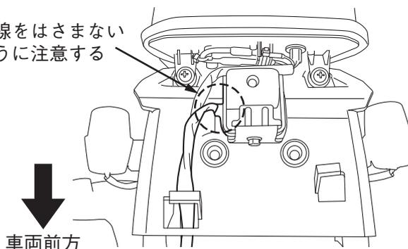
10.ステアキャリア1③・2④を車両にスタンダード車のボルトで仮止めします。
