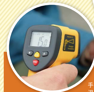
赤外線放射温度計を使い、グローブの温度を測定。
