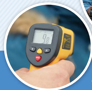
赤外線放射温度計を使い、ウエア表面の温度を測定。
