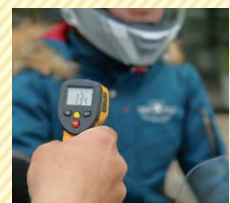
赤外線放射温度計を使い、ウエア表面の温度を測定。
