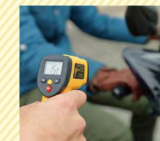
赤外線放射温度計を使い、グローブの温度を測定。
