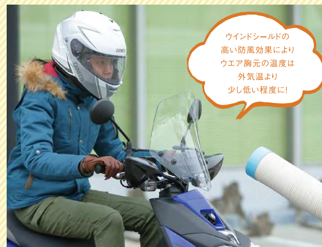
ライダーの胸元に向けられているスポットエアコンからの風をウインドシールドがブロックしている。
