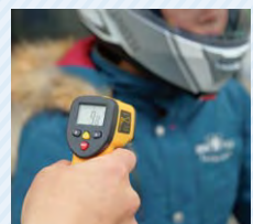
赤外線放射温度計を使い、ウエア表面の温度を測定。
