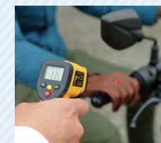
赤外線放射温度計を使い、グローブの温度を測定。
