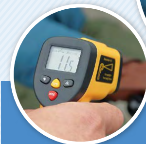
赤外線放射温度計を使い、グローブの温度を測定。
