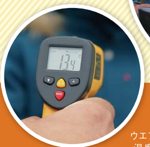
赤外線放射温度計を使い、ウエア表面の温度を測定。
