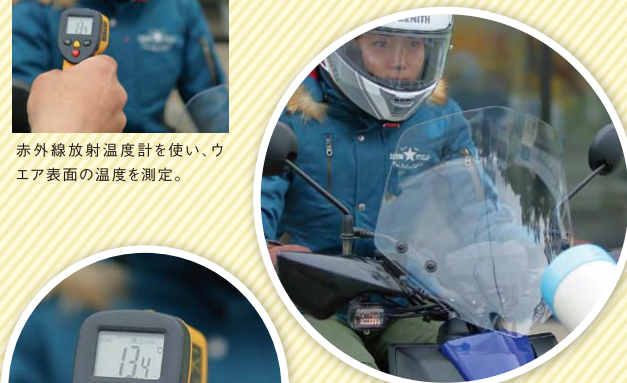
ライダーの胸元に向けられているスポットエアコンからの風をウインドシールドがブロックしている。
