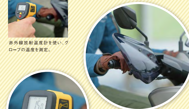
ライダーの手元に向けられているスポットエアコンからの風をナックルバイザーがブロックしている。
