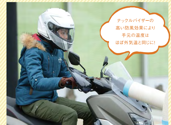
ライダーの手元に向けられているスポットエアコンからの風をナックルバイザーがブロックしている。
