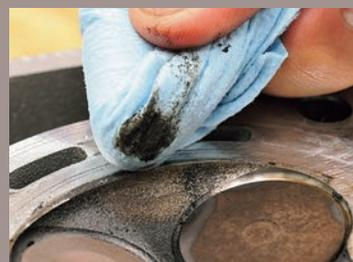
テスト前、スキッシュエリアのカーボンはカチカチで岩肌を撫でているようだったが、投入後600kmで軽く拭い取れるほど軟化した。分解せず確実なクリーニング効果が得られるのは魅力的だ。
