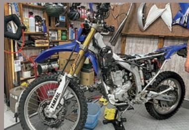
ビッグタンクに交換しているため容量は純正より多い11リットルで、付属の計量カップで33ccを添加。ピストン上部だけならスパークプラグ孔からファイバースコープを挿入して見えるが、燃焼室面まで比較検証するためシリンダーヘッドを3回着脱した。スペースはギリギリだが、フレームにエンジンが載った状態でヘッドを着脱できるのは整備性が高い。
