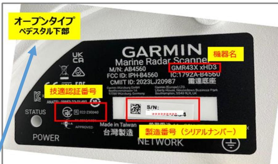
ベDESTAL下部カバー内（ネジ留め）にありますので、カバーを外してご確認ください。
