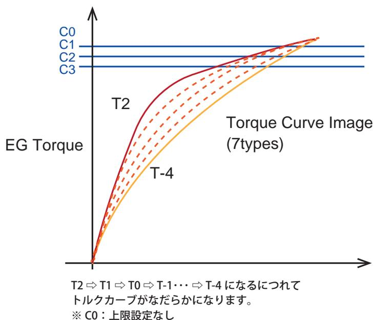
トルクカーブ毎にピークパワーを抑える 3 モードを設定しています。(C1~C3)
