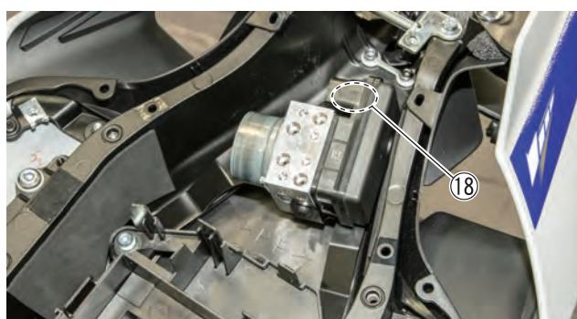
8. ラジエター左側に取り付けられている STD のレクチファイヤー / レギュレータを車体から取り外します。
