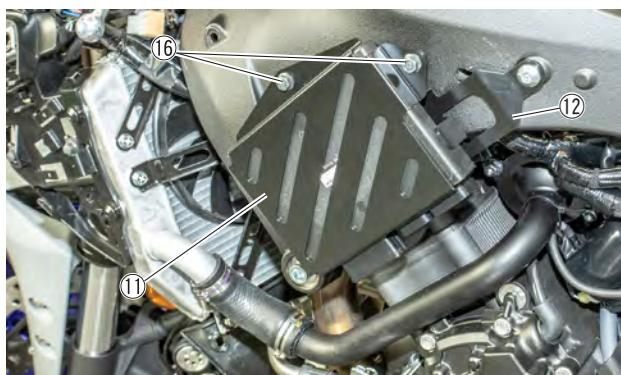
6. Hydraulic unit と EXUP servo motor を車体から取り外します。
