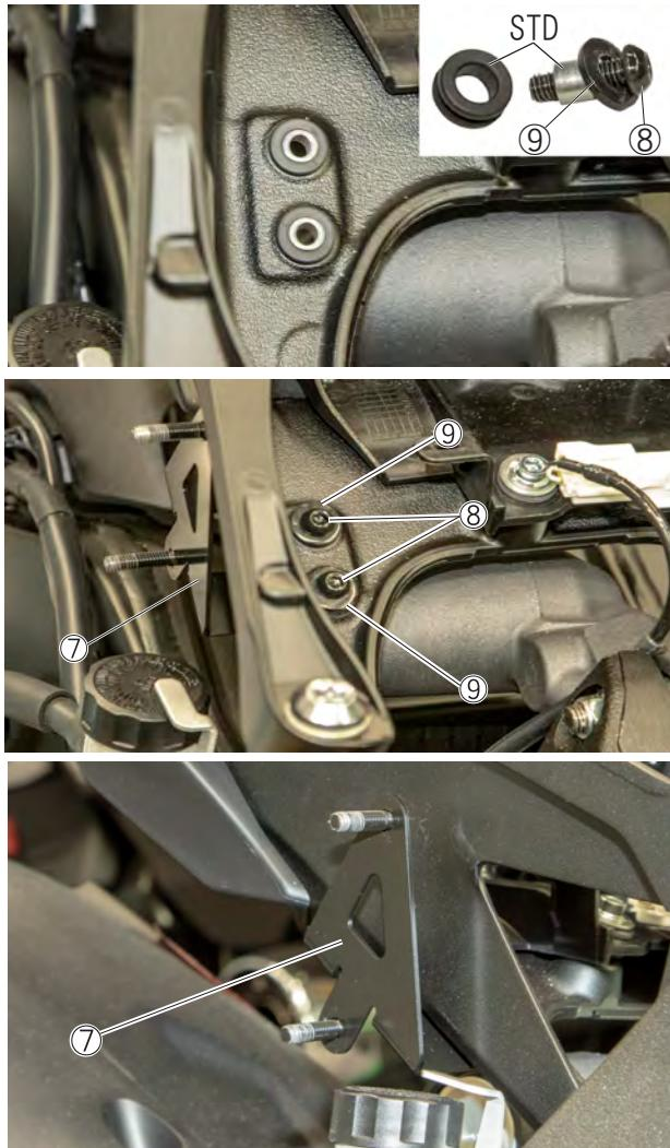
10. レクチファイヤー / レギュレータを NUT,U FLANGE ⑩を使用して BRKT., REGULATOR 1 ⑦に取り付けます。
