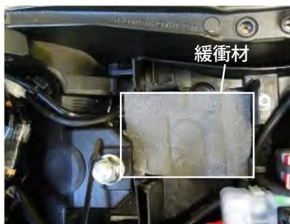
8. 衝撃吸収材の上に Hydraulic unit assy. を取り付けます。
