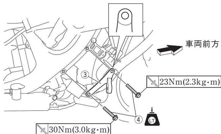
※イラストは車両右側ですが、左側も同様に組み付けます。
