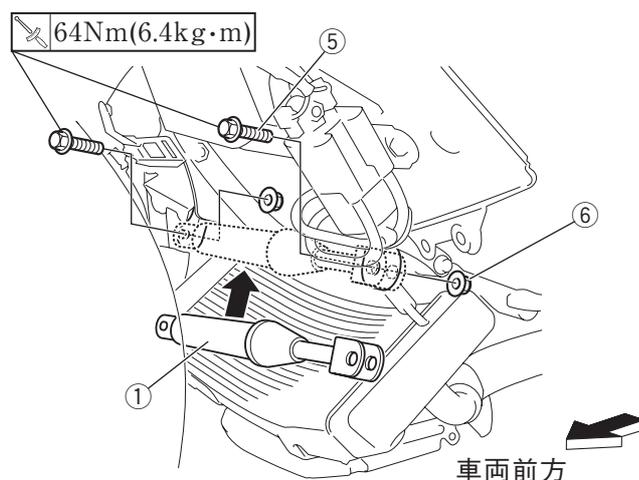
4. 取り外した車両部品を元の位置に組み付けます。
