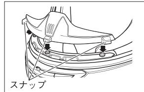
ブレスガードとフロントベンチレーションの上のスナップ（3ヶ所）を合わせ、「パチン」と音がするまで押さえ付けます。
