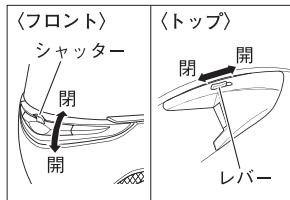
開けるときは、フロントはシャッターを下に、トップはレバーを後ろ側にスライドさせます。閉めるときは、フロントはシャッターを上に、トップはレバーを前側にスライドさせます。
