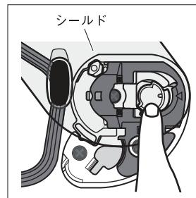
④シールドのツメ部分を押さえ付け、ツメを奥まで押し込みます。
