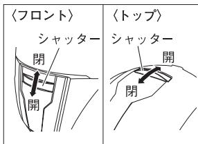
開けるときは、シャッターをフロントは下に、トップは後ろ側にスライドさせます。閉めるときは、シャッターをフロントは上に、トップは前側にスライドさせます。
