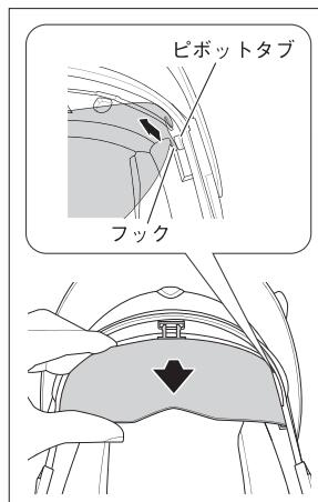
③サンバイザーの両側にあるフックをピボットタブから引き抜きます。
