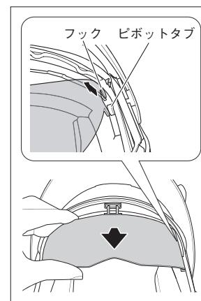
③サンバイザーの両側にあるフックをピボットタブから引き抜きます。
