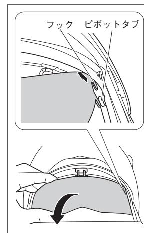
③サンバイザーの両側にあるフックをピボットタブから引き抜きます。
