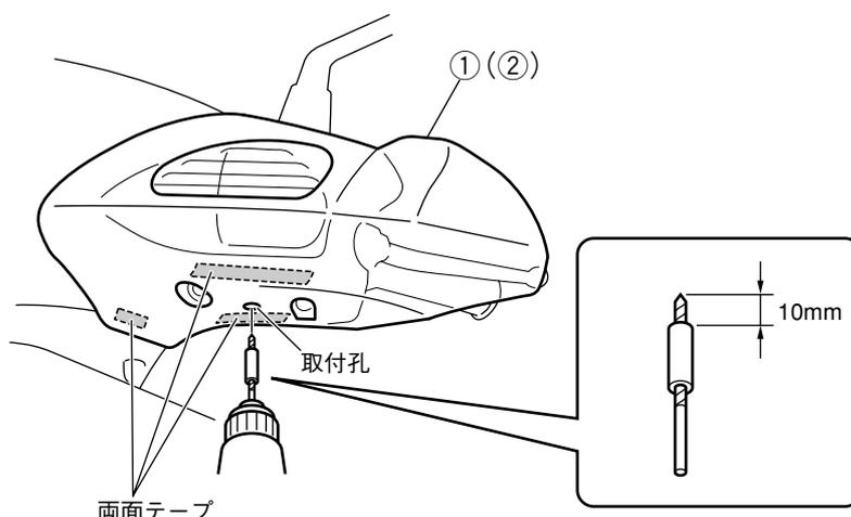
4. ナックルバイザー下側の取付孔にリベット③を差し込み、固定します。
