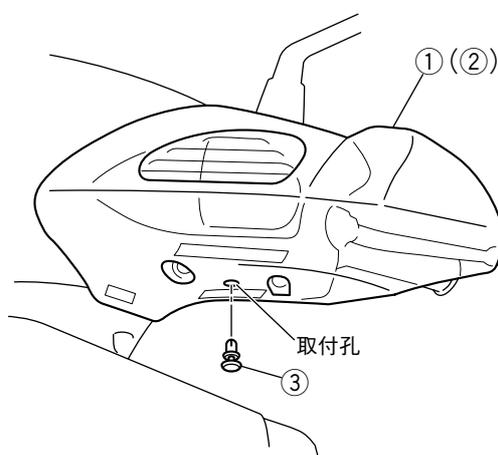
図は左側の取り付けを説明しています。右側も同様に取り付けてください。
