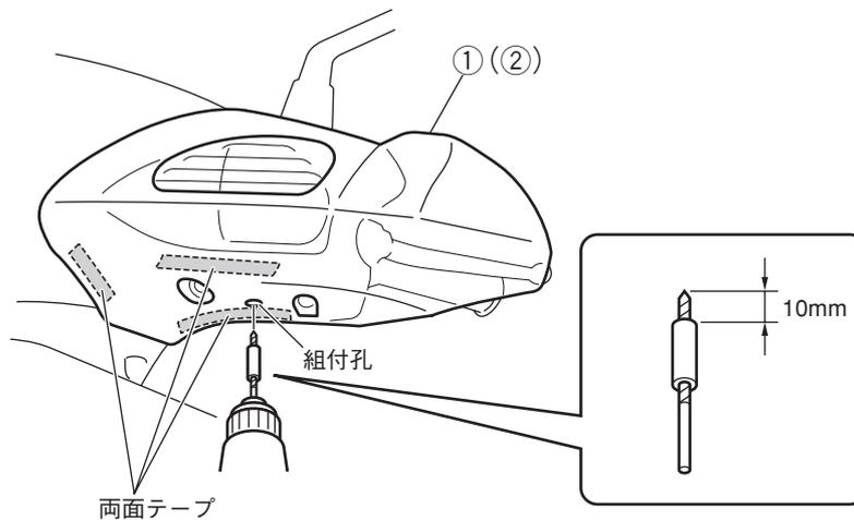
4. ナックルバイザー下側の組付孔にリベット③を差し込み、固定します。
