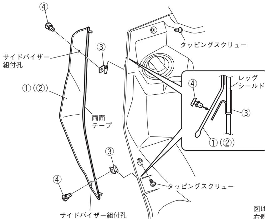
図は左側の組み付けを説明しています。右側も同様に組み付けてください。
