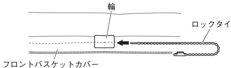
2. 車両のバスケット外側にフロントバスケットカバーを、バスケットとカバーのセンターが合うようにかぶせます。
