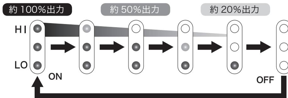
・インジケータランプの点灯、点滅によるグリップヒータの作動状態、バッテリーの状態は次のようになります。
