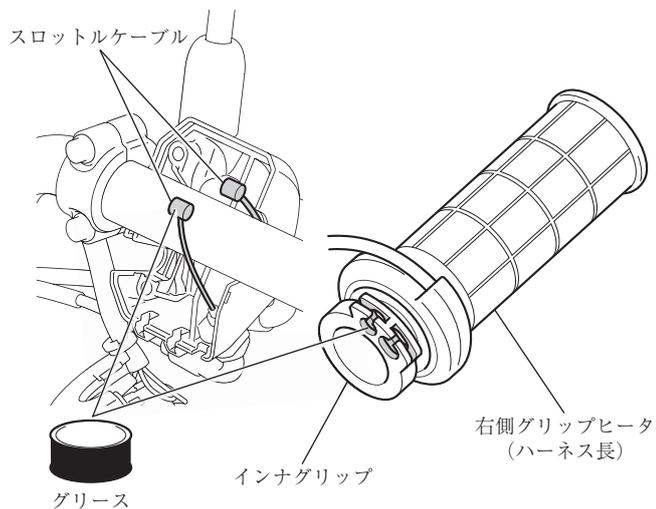
5) 取り外しの逆手順で右側グリップヒータ、スロットルハウジングを取り付ける。
