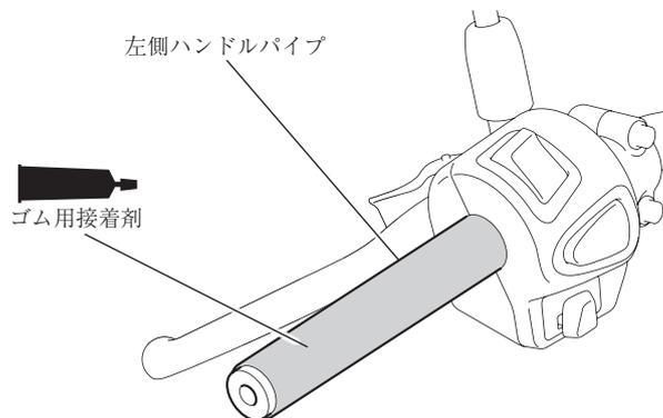
6) 脱脂洗浄剤を左側グリップヒータ内周面、左側ハンドルパイプ外周面にスプレーする。
