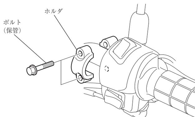
3) 図のようにヒータスイッチを取り付ける。
