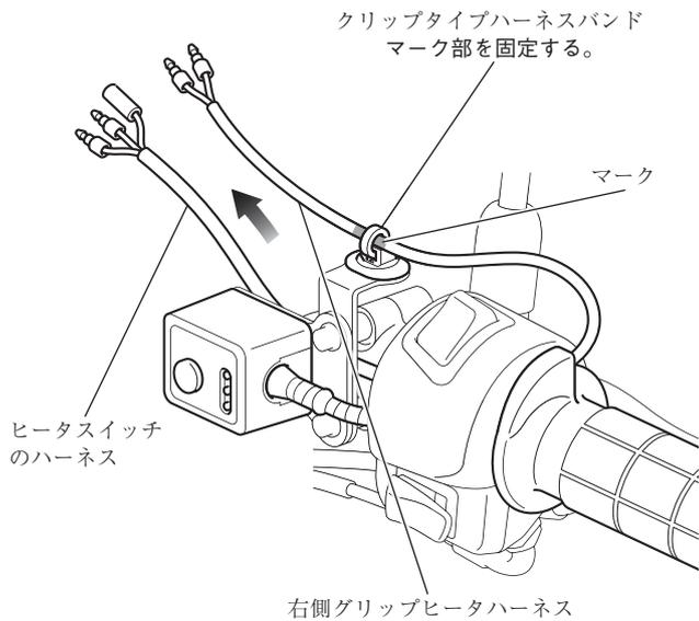
5) 図の寸法でグリップヒータハーネスにマークを付ける。
