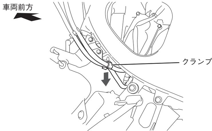
4. フートレストを固定しているボルト2本を取り外し、車両左側はブラケット1④とカラー⑥をソケットヘッドボルト⑤と取り外したボルトで取り付けます。車両右側はブラケット2⑦とカラー⑨をソケットヘッドボルト⑧と取り外したボルトで取り付けます。
