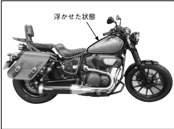
(1) 車体の点線部のシート及び、外装を取り外して、ガソリタンクを浮かせられる状態にしてください。
