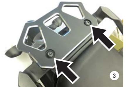
3) 純正ボルトでテールプレートを取り付けます。(下図参照)
