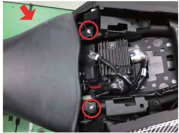
2-5. ヒューズBOXを取り外し、ナンバー灯・ウインカー配線を外します。
