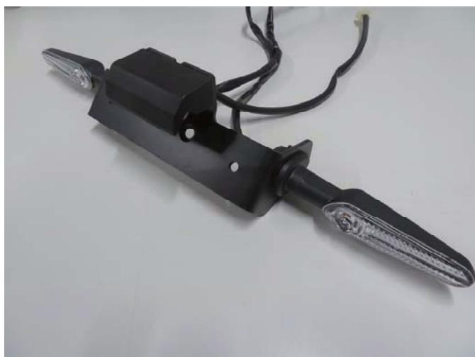
3-1. ③ウインカーステーに純正ウインカーと⑥ナンバー灯を取り付けます。
