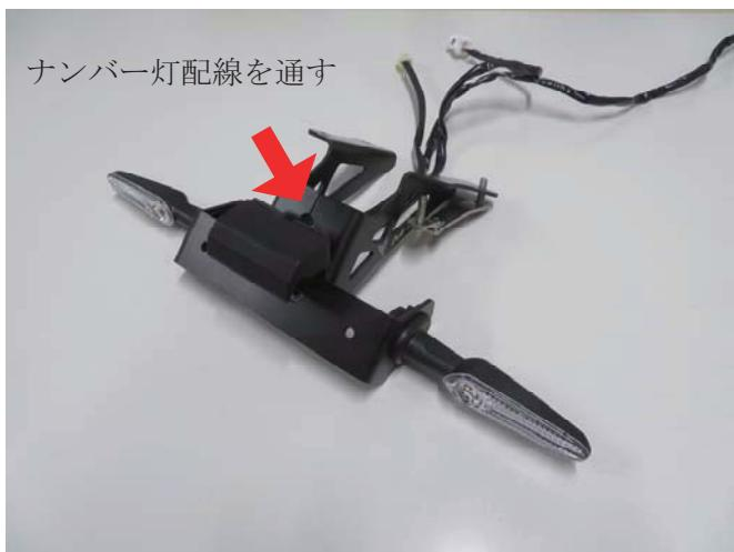
3-2. ③ウインカーステーに②③サイドステーL/Rを⑨M6皿ボルト⑩M6ロックナット⑪M6ワッシャーを使用して仮締めしておきます。
