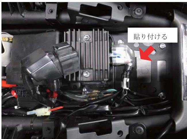
3-5. 配線を車体へ入れて、⑥スポンジシートを点線のようにカットして 矢印の箇所へ貼り付け、配線穴を隠します。
