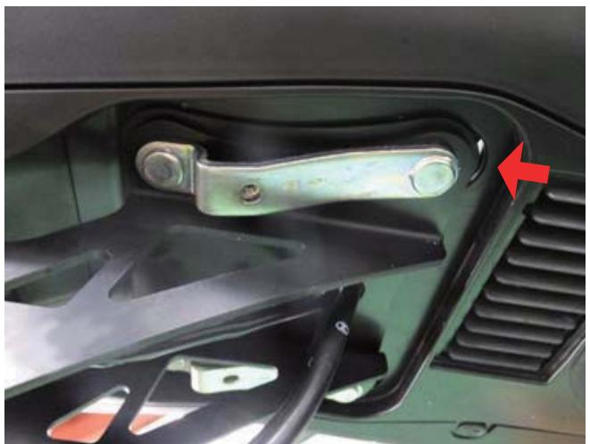
3-4. 取り外した純正ナットを使用してフェンダレスキットASSYを車体へ取り付けます。
