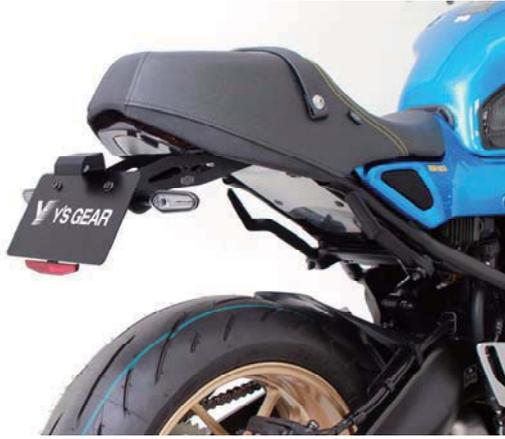
3-7. 全体の位置を確認し増締めし、取り外した外装を取り付けます。
