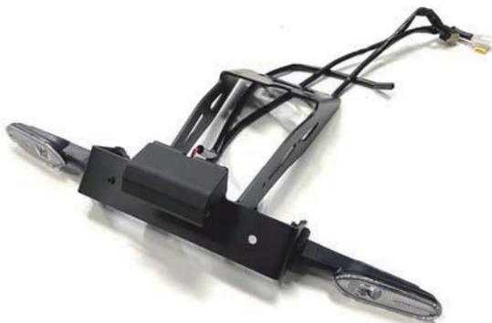
3-2. ③ウインカープレートに②メインプレートを仮組みします。
