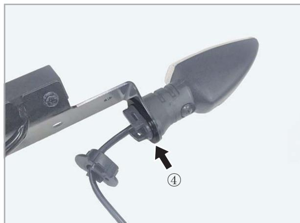
3-2. ステー内側の隙間に【④ウインカー Spacer】を入れます。(左右に入れます)
