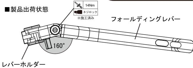
当製品は純正レバー形状に合わせ、可倒部分に角度をつけた設計となっております。製品組み立て時に角度調整を行ったうえで出荷しておりますので、開封時はそのまま車体に装着して頂いて問題ございません。角度調整が再度必要な場合は左図をご参照ください。
