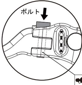
ボルトにはネジロック（低強度）を塗布し取り付けてください。
