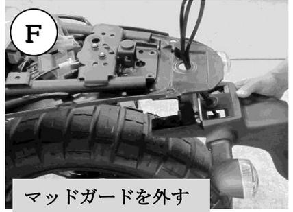
3. ナンバー灯コネクタ、ウインカーギボシを外してマッドガードASSYを外します。(写真D/E/F参照)
