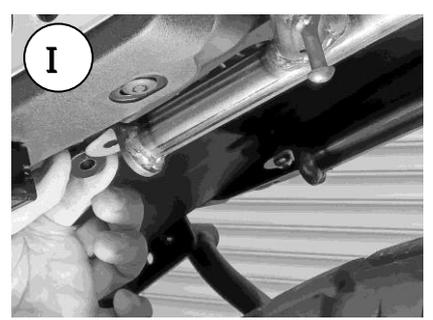
4. マッドガードASSYのスタッドボルトを本体①ステー部の穴に通して、純正ナットで仮固定します。(写真G/H参照)
