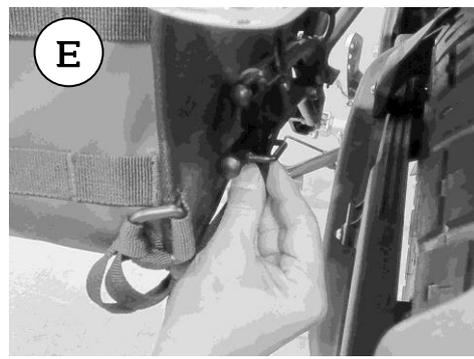
3. 本体の折り曲げ2か所がタンデムブラケットにあたるように押しながら本締め付けます。(写真D参照)
