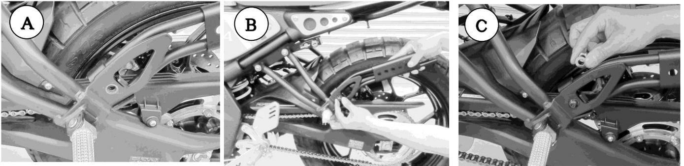
1. タンデムステップを出して本体①をタンデムステップブラケットの内側からあてがい折り曲げ部とタンデムブラケットを合わせます。(写真A/B参照)
