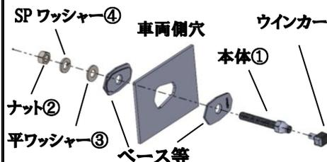
※ウインカーを平ワッシャー/SPワッシャー/ナットを使用し車両に固定する。車両によっては、SPワッシャー等を使用しない。
