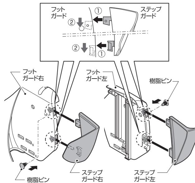
2. 巻き込みガード(左右)を本体の巻き込みガード用穴に差込んで、15mm程度後方へスライドさせ、巻き込みガード固定ネジでしっかりと固定します。(ハンドルも固定されます)。
