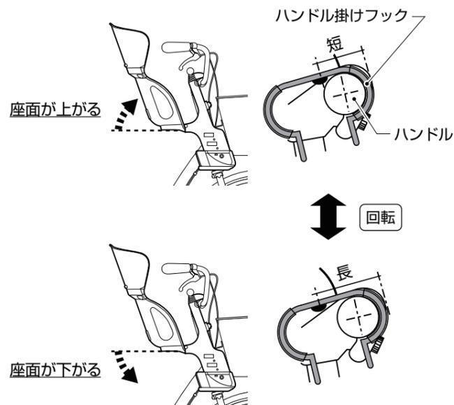
2. ハンドル固定部品に板ナットを差し込み、自転車のハンドルの下からハンドル固定部品をあて、ハンドル掛けフックに固定ネジ (M5×18ネジ) で固定します。(※左右とも同じです)
