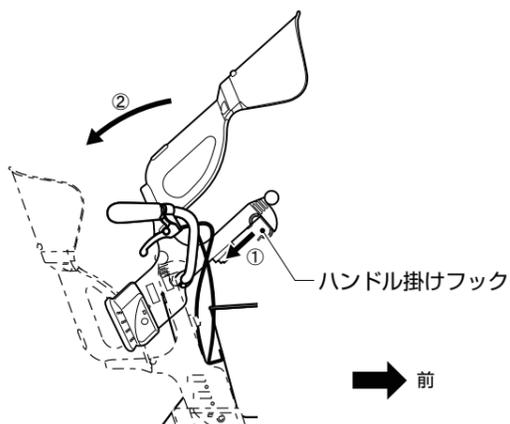
**注意** チャイルドシートの座面がお子さまを乗せた状態で水平になるように、ハンドル掛けフックを回転させ調整してください。
