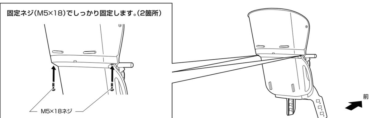
3. ステップ用穴にステップを取付けます。
