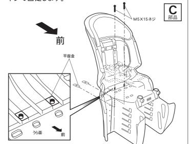
③背もたれ部と股部のつなぎ目の両端を平座金とM5×35 ネジで固定します。
