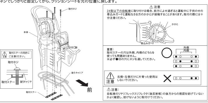
⑦ステップ右とステップ左を股部のステップ用穴に差込んで、50mm程度後方にスライドさせ、M5×15ネジとツバ付袋ナットで しつかり固定します。
