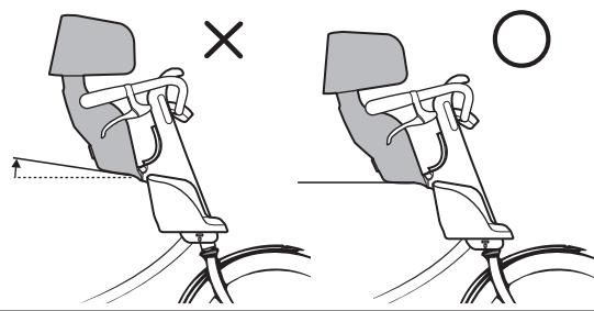
△ 注意 自転車に取付けた時に、座面(お子さまが座る部分)が地面に対して前に傾く自転車には取付けないでください。
