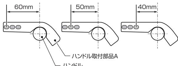
・自転車に合わせたら、ハンドル取付部品A(右)(左)を取付ネジでしっかりと固定してください。
