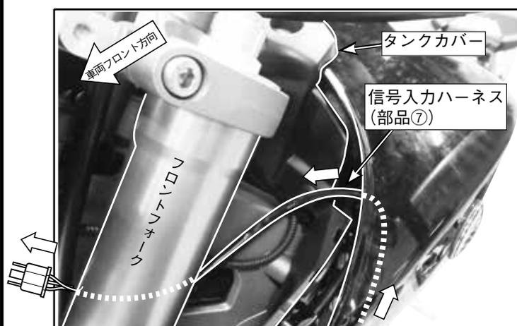
11. 10 で取り付けした信号入力ハーネス (部品⑦) を写真のように取り回し、フロントフォークの内側を通してヘッドライトユニットにある車両側信号取り込み部と接続してください。
