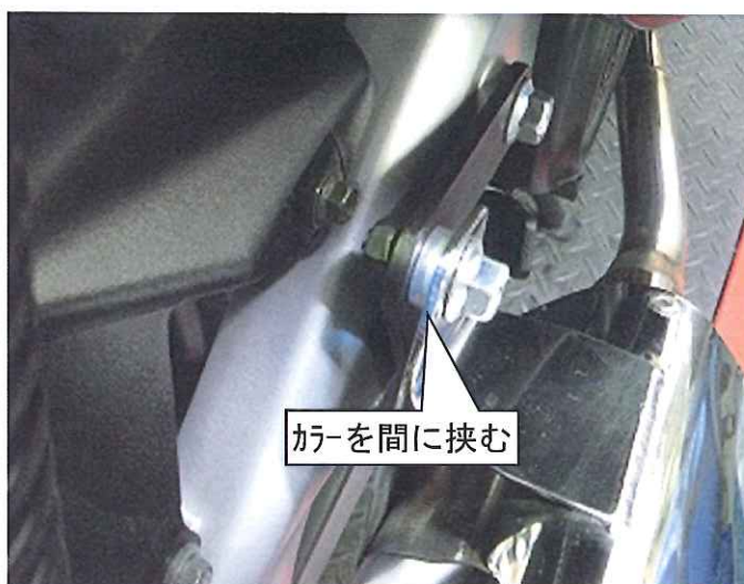
写真5 サイレンサー取付け (上側)
