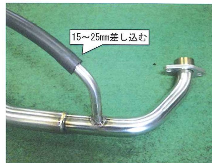
写真3 AIホース取付け (EXパイプ側)
