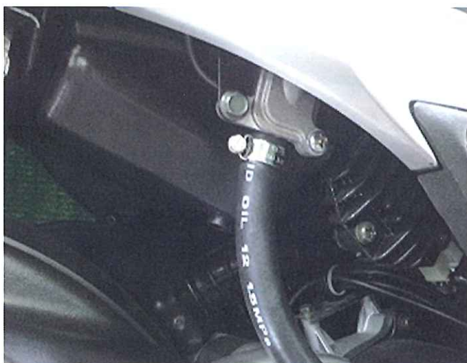
写真4 AIホース取付け (リードバルブ側)
