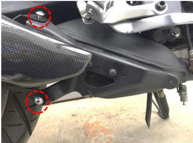
・①サイレンサーをチャンバーに差し込み、②M6ボルト(L=20)を使用して、プロテクターステーに仮止めします。
