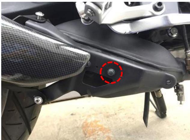
・①サイレンサーを仮止めしたままの状態で、プロテクターステーの前側のボルトを本締めします
