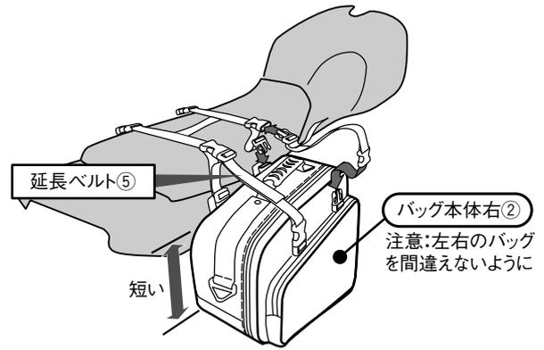
4. バッグ本体左①、右②が傾いたりウインカー・マフラー等に接触しないように、各ベルトの長さを調節します。
