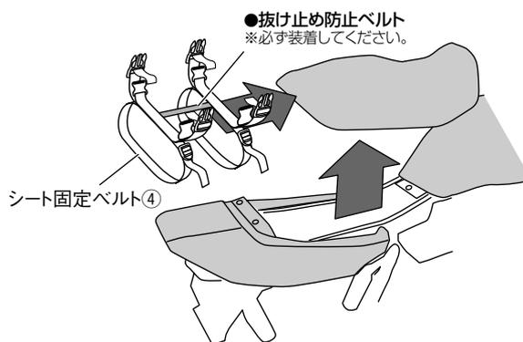
2. バッグ本体左①、右②の組付位置を考慮し、バックルの位置に合わせてシート固定ベルト④の位置を決めます。位置が決まったらシートに固定し、シートを車両に組み付けます。
