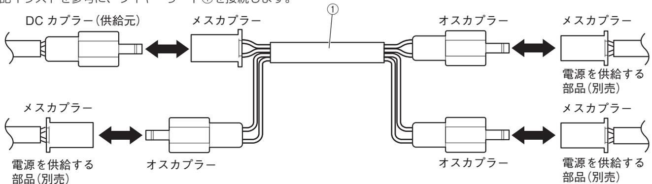
2. 電源を供給する部品のリード線の⊕が茶線、⊖が黒線になるように接続します。
