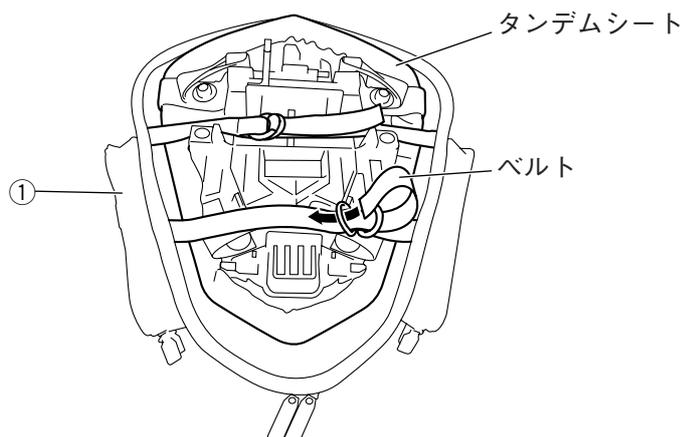
3. タンデムシートを車両に組み付けます。
