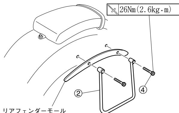
図は右側を示します。左側も同様に取り付けてください。
