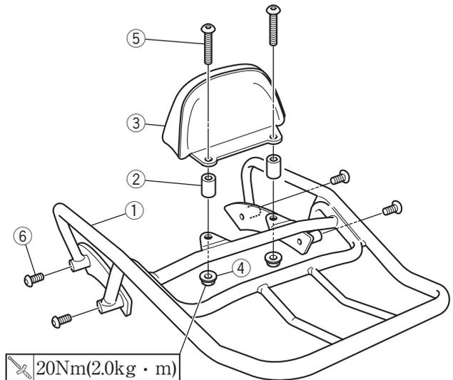
4.キャリア①を車両の取り外したボルトの位置に、ソケットボルト⑤で組み付けます。
