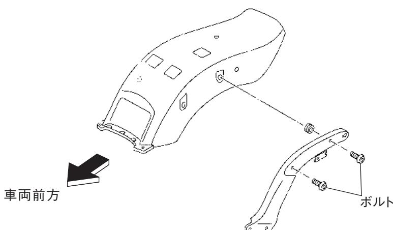
2.取り外したボルトの位置にサイドバッグステー①を、ヘキサゴンボルト③で組み付けます。
