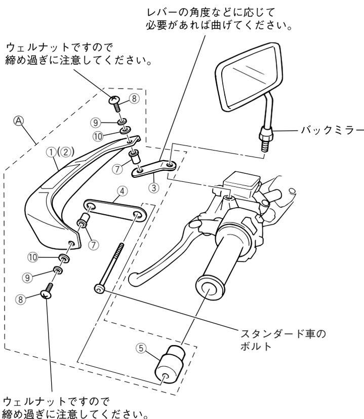
5. グリップカウルL①・R②を各レバーと干渉しない位置に調整し、スクリュー⑧で締め付けます。
