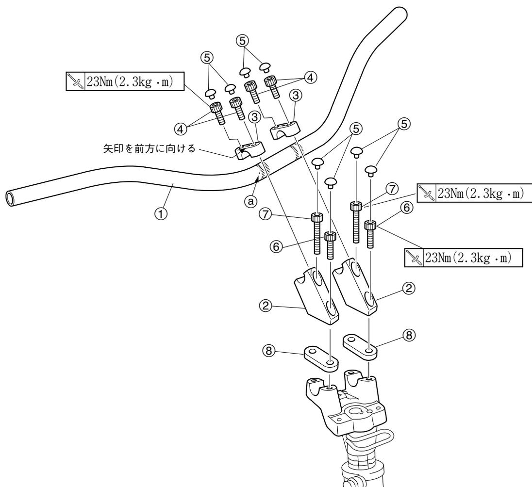
ハンドルアッパーホルダーボルトは先に前側のすき間がなくなるまで締め付け、次に後ろ側を締め付けてください。
